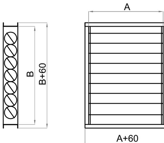
Клапаны АВК изготавливаются в любом размерном сочетании, минимальный размер клапана 150x150 мм.
